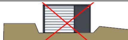
Der Siphon im Kondensatablauf (nur nötig, bei Abfuhr in die Kanalisation) liegt nicht im frostsicheren Bereich. Die Kondensatablaufheizung muss bei der Inbetriebnahme so konfiguriert werden, dass diese bei Frostgefahr durchläuft (Achtung erhöhte Stromkosten). Standardmäßig läuft die Kondensatablaufheizung nur bei und kurzzeitig nach der Abtauung.
