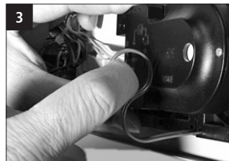
3 Sprechanlage hinter die Befestigungsbügel klemmen.
