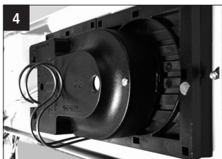
1 Innenansicht mit Lautsprecheradapter und Befestigungsbügel
