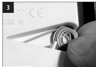
Entnahme Entriegelungsschlüssel auf der Rückseite.
