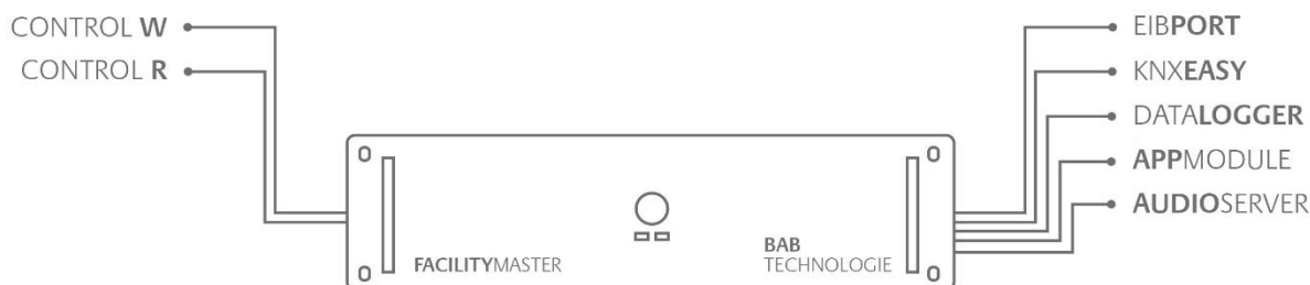
Abbildung 2: FACILITY MASTER Funktionsübersicht
