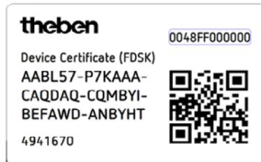
Die ETS erzeugt nach Eingabe des FDSK einen gerätespezifischen Werkzeugschlüssel. Über den Bus sendet die ETS den Werkzeugschlüssel zum Gerät, das konfiguriert werden soll. Die Übertragung wird mit dem ursprünglichen und vorher eingegebenen FDSK-Schlüssel verschlüsselt und authentifiziert. Weder der Werkzeug- noch der FDSK-Schlüssel werden im Klartext über den Bus gesendet.
