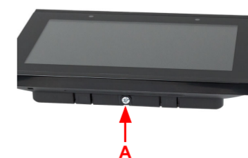
Abb. 6 Fixieren Sie die Displayeinheit von unten mit der mitgelieferten Schraube (A).
