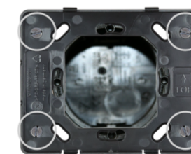
Abb. 3 Falls die Schraubdome der verwendeten Dose sich nicht mit den Langlöchern der Montage-Einheit decken, kann die Montage-Einheit alternativ über die anderen Löcher verschraubt werden (z. B. bei anderen Systemen).
