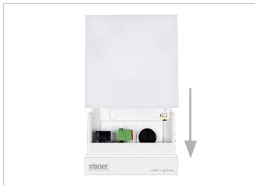
Abb. 13 Stecken Sie die Haube auf das Unterteil. Dabei wird die Steckverbindung zwischen der Platine in der Haube und der Anschlussbuchse im Unterteil hergestellt.
