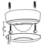
Der Melder muss auf eine ebene, feste Unterlage montiert werden. Es sind keine Aufputzrahmen oder Unterputzdosen erforderlich.
