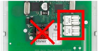
Entfernen Sie die rot-schwarze KNX-Busklemme, sie wird nicht benötigt.
