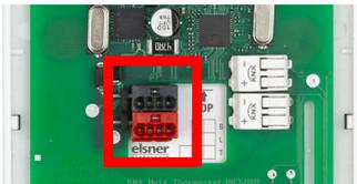
Wenn sich hinter dem Gerät ein Hohlraum befindet, z. B. bei Verwendung einer Dose, dann können Sie die rot-schwarze KNX-Busklemme zum Anschluss verwenden.
