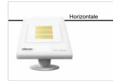
Abb. 3 Das Gerät muss in der Querrichtung horizontal (waagrecht) montiert sein.
