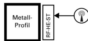
Das Antennen-Symbol auf dem Gehäuse zeigt die Position der Antenne im **RF-HE-ST**. Diese Seite darf nicht direkt an Metallflächen oder -gegenständen positioniert werden. Das Funksignal kann sonst gestört werden.
