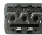
Abb. 3b: Anschluss Motor 1: N | 2: Auf 3: Ab PE: ↓
