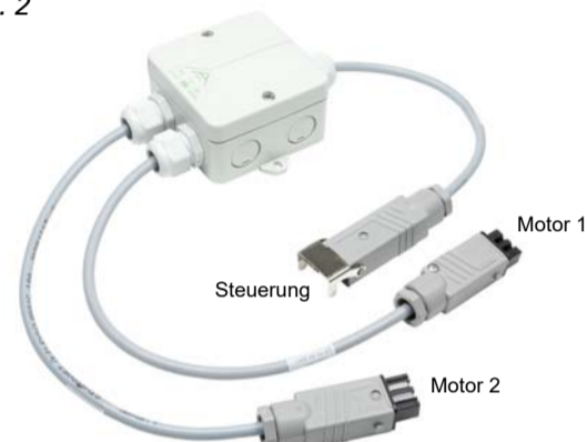
Abb. 3a: Anschluss Steuerung 1: N | 2: Auf 3: Ab PE: ↓
