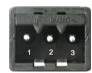
Abb. 3a: Anschluss Steuerung 1: N | 2: Auf 3: Ab PE: ↓
