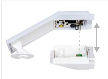
Abb. 7 Ziehen Sie Deckel und Unterteil gerade auseinander. Dabei wird die Steckverbindung zwischen der Platine im Deckel und der Anschlussbuchse im Unterteil gelöst.
