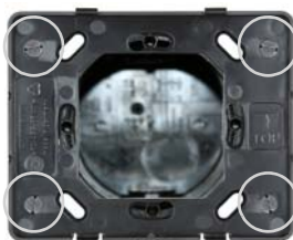
Abb. 3 Falls die Schraubdomen der verwendeten Dose sich nicht mit den Langlöchern der Montage-Einheit decken, kann die Montage-Einheit alternativ über die anderen Löcher verschraubt werden (z. B. bei anderen Montagesystemen)
