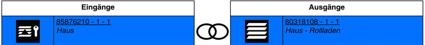
Schließen des Eingangskontakts: aktivierung der zwangssteuerung und verzögertes schließen des ausgangskontakts auf.
