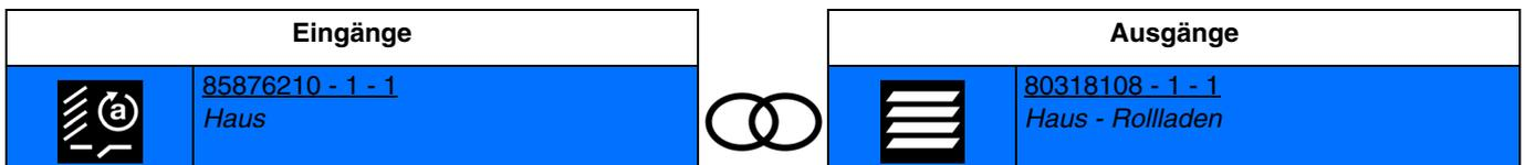
Schließen des Eingangskontakts: verzögertes schließen der ausgangskontakte für die position 1 der jalousie-lamellen.
