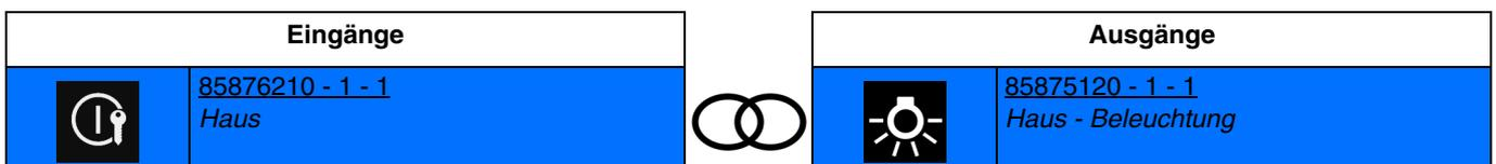
Die Aktivierung des Eingangs bewirkt die Zwangssteuerung des Ausgangs bei AUS.
