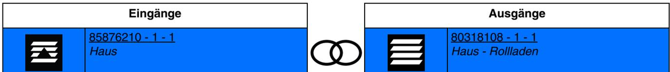
Die Aktivierung des Eingangs bewirkt das zeitverzögerte Schließen des Ausgangskontakts Auf (funktion auf eines rolldadens oder einer jalousie).
