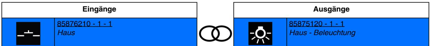
Die Aktivierung des Eingangs durch kurzes Drücken bewirkt das Umschalten zwischen Einschalten und Ausschalten. Aufeinanderfolgende Aktivierungen kehren jedes Mal den Zustand des Ausgangskontakts um.
