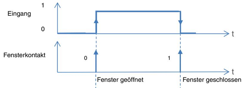
*Hinweis: Standardmäßig funktioniert der Eingang wie ein Schließer (Schließer). Wenn der Parameter **Umgekehrt** bestätigt wurde, funktioniert der Eingang wie ein Öffner (Öffner).*
