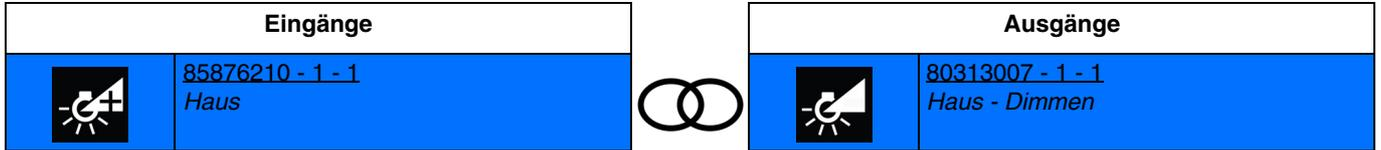
Die Aktivierung des Eingangs durch kurzes Drücken bewirkt das Einschalten des Lichts auf der zuletzt gespeicherten Stufe.
