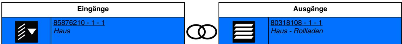
Die Aktivierung des Eingangs durch kurzes Drücken bewirkt das kurze Schließen des Ausgangskontakts Ab (funktion ausrichtung der lamellen einer jalousie).
