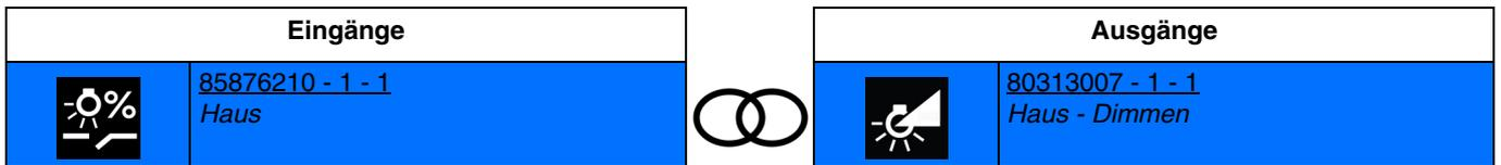
Schließen des Eingangskontakts: das Licht wird auf dimmwert 1 angeschaltet.
