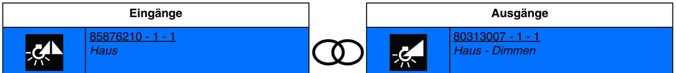
Die Aktivierung des Eingangs durch kurzes Drücken bewirkt das Umschalten zwischen Einschalten auf der letzten gespeicherten Stufe und Ausschalten des Lichts.
