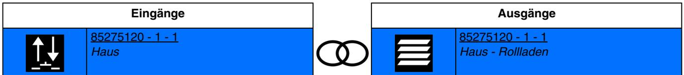
Schließen des Eingangskontakts: verzögertes schließen des ausgangskontakts auf oder ab.
