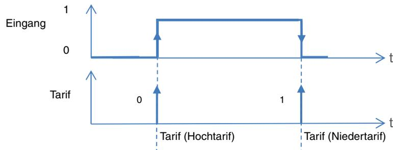
*Hinweis: Standardmäßig funktioniert der Eingang wie ein Schließer (Schließer). Wenn der Parameter **Umgekehrt** bestätigt wurde, funktioniert der Eingang wie ein Öffner (Öffner).*
