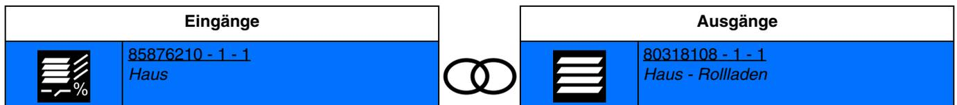
Schließen des Eingangskontakts: verzögertes schließen der ausgangskontakte für die position 1 des rollladens oder der jalousie und für die position 1 der jalousie-lamellen.
