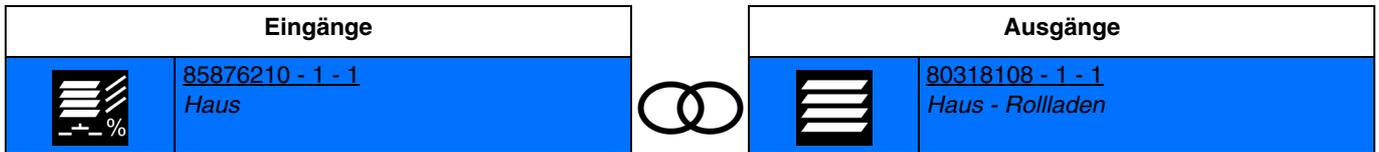
Die Aktivierung des Eingangs bewirkt das zeitverzögerte Schließen der Ausgangskontakte für die Positionierung des Rollladens oder der Jalousie und für die Neigung der Lamellen der Jalousie.
