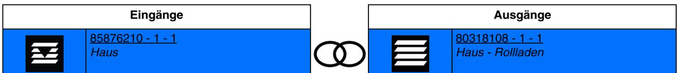
Die Aktivierung des Eingangs bewirkt das zeitverzögerte Schließen des Ausgangskontakts Ab (Funktion Ab eines Rolldadens oder einer Jalousie).
