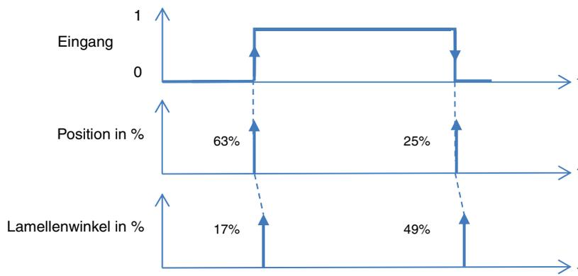
Hinweis: Der Wert des Objekts **Position in %** wird vor dem Wert des Objekts **Lamellenwinkel in %** ausgegeben, damit das Ausgangsmodul Rollladen die Jalousie positionieren kann, bevor sie geneigt wird.
