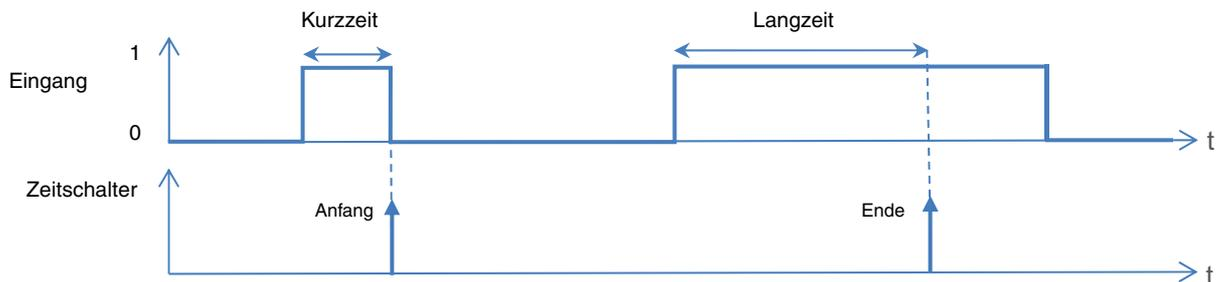
Mit der Zeitschalter-Funktion kann ein Beleuchtungskreis für eine einstellbare Dauer eingeschaltet werden.
