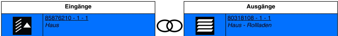
Die Aktivierung des Eingangs durch kurzes Drücken bewirkt das kurze Schließen des Ausgangskontakts Auf (funktion ausrichtung der lamellen einer jalousie).
