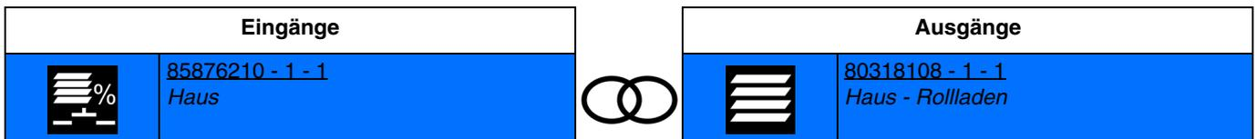
Die Aktivierung des Eingangs bewirkt das zeitverzögerte Schließen der Ausgangskontakte für die Positionierung des Rollladens oder der Jalousie.
