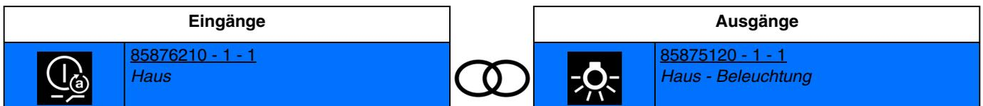
Das Schließen des Eingangskontakts bewirkt das Einschalten des Lichts. Das Öffnen des Eingangskontakts bewirkt das Ausschalten des Lichts.
