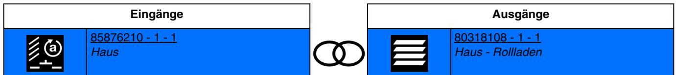
Die Aktivierung des Eingangs bewirkt das zeitverzögerte Schließen der Ausgangskontakte für die Neigung der Lamellen der Jalousie.
