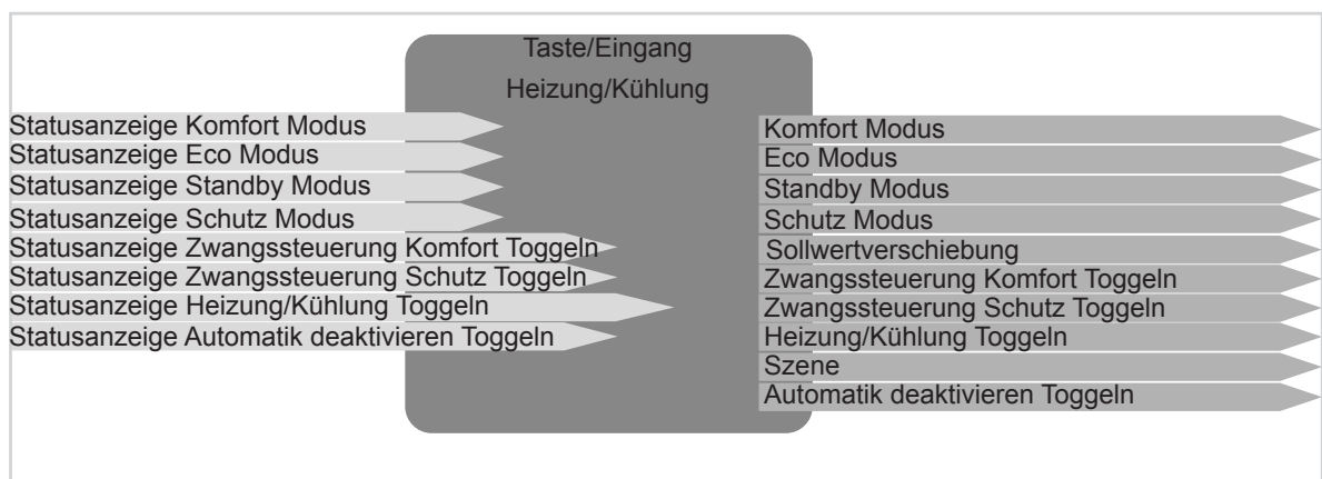
Bild 7: Ein-/Ausgangssignale Funktion Heizung/Kühlung
