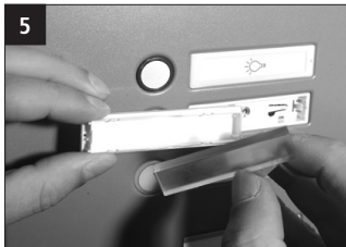
5 Kunststoffscheibe an der Rückseite des Namensschildes entnehmen.
