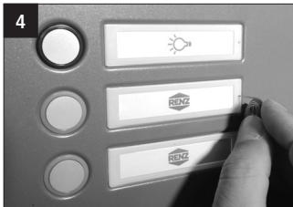
4 Entriegelung des Namensschildes durch Eindrücken des Entriegelungsschlüssels in die Bohrung auf der rechten Seite des Namensschildes.
