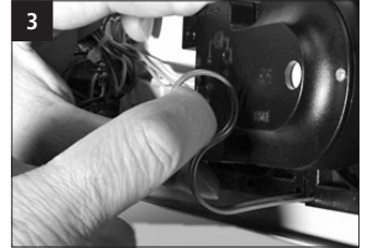
3 Sprechanlage hinter die Befestigungsbügel klemmen.
