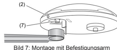
Bild 7: Montage mit Befestigungsarm
