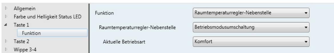
Bild 29: Funktion der Einzeltaste „Raumtemperaturregler-Nebenstelle“
