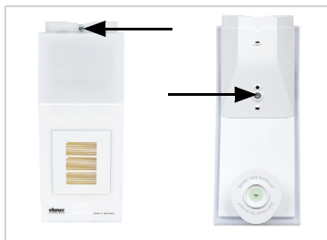
Abb. 5 Lösen Sie die beiden Schrauben an Deckel (oben) und Unterteil (unten) mit einem Torx-Schraubendreher der Größe 6.
