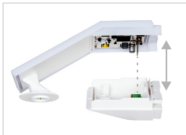
Abb. 6 Ziehen Sie Deckel und Unterteil gerade auseinander. Dabei wird die Steckverbindung zwischen der Platine im Deckel und der Anschlussbuchse im Unterteil gelöst.
