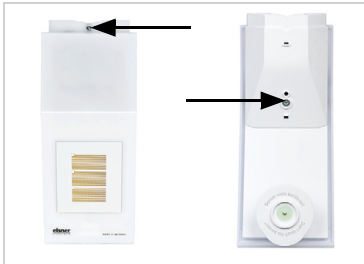
Abb. 15 Verschrauben Sie Deckel (oben) und Unterteil (unten).
