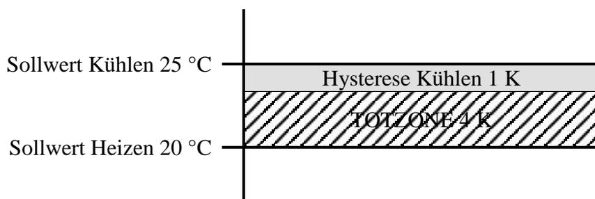
Die Totzone (4 K) wird um den Wert der Hysterese (1K) erhöht und verschiebt den Sollwert für Kühlen auf 25 °C.
