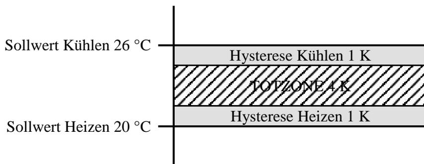
Die Totzone (4 K) wird um den Wert beider Hysterese (2K) erhöht und verschiebt den Sollwert für Kühlen auf 26 °C.
