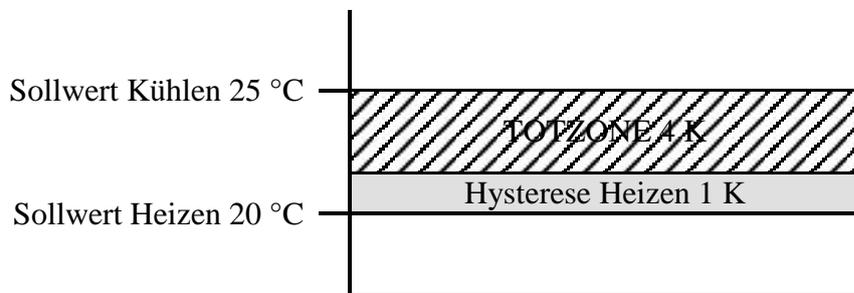
Die Totzone (4 K) wird um den Wert der Hysterese (1K) erhöht und verschiebt den Sollwert für Kühlen auf 25 °C.
