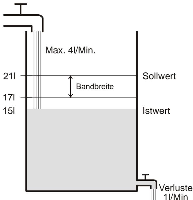
Beträgt die Füllmenge 15l, ergibt sich eine Regelabweichung von  $21l - 15l = 6l$ . Da unser Istwert außerhalb der Bandbreite liegt, wird der Regler den Zulauf mit 100% d.h. mit 4l / Minute ansteuern.
