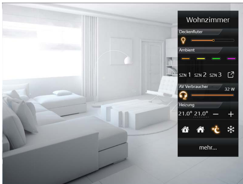
Abbildung 7 Instant Control Panel (rechts zu sehen)
