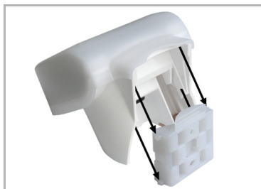
Abb. 16 Schieben Sie das Gehäuse von oben in den montierten Halter. Die Zapfen des Halters müssen dabei in den Schienen des Gehäuses einrasten.
