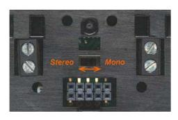
Schließen Sie die Lautsprecher an die dafür vorgesehenen Klemmen an. Stecken Sie dazu das Kabel in die Klemmen und schrauben es mit den an der Frontseite zugänglichen Schrauben fest.
