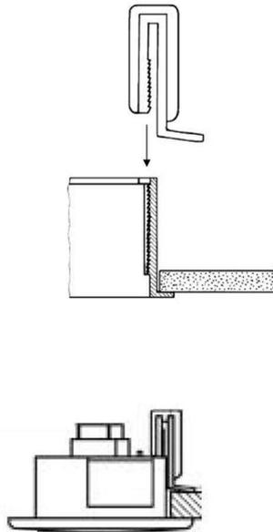
Sägen Sie den Deckenausschnitt (120mm Durchmesser) aus.
