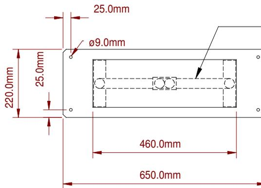
in der mittleren Aussparung sind 2 flexible Kunststoffrohre KU-E-LF 32mm nach außen in das Hohlprofil gezogen. Die beiden Hohlprofile 40x150mm (Außenmaß) dienen als Trägerprofil und als Kabelkanal.
