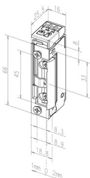
Modell mit Rückmeldekontakt als potentialfreier Wechselkontakt. Dieser wird von der Schlossfalle betätigt.
