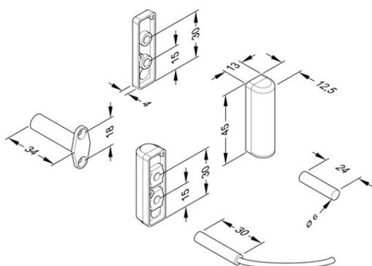
Sämtliche Magnetkontakte bestehen grundsätzlich aus einem Reedkontakt und einem Permanentmagneten. Im Reedkontakt befindet sich ein Schalter, der staub- und wasserdicht in einem Glasröhrchen eingeschmolzen ist.
