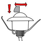
Falls der Erfassungsbereich des LUXOMAT® PD9-M-1C+HKL zu groß ist, oder Bereiche abgedeckt sind, welche nicht überwacht werden sollen, kann mit den beiliegenden Abdeckclips der Bereich nach Bedarf reduziert bzw. eingeschränkt werden.
