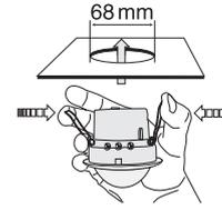
In der Decke muss zuerst eine runde Öffnung mit 68 mm Durchmesser erstellt werden.
