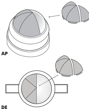
Falls der Erfassungsbereich des LUXOMAT® PD4-M-1C-K zu groß ist, oder Bereiche abdeckt, welche nicht überwacht werden sollen, kann mit den beiliegenden Abdeckclips der Bereich nach Bedarf reduziert bzw. eingeschränkt werden.
