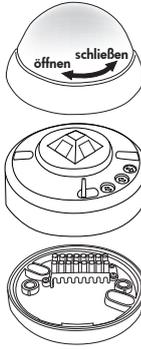
Der Melder muss auf eine ebene, feste Unterlage montiert werden. Vor der Montage muss die Linse entfernt werden. Dazu ist die Linse im Gegenuhrzeigersinn um ca. 5° zu drehen und abzunehmen.
