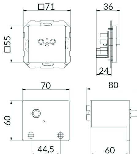
Vorverstärker zum Anschluss einer Linequelle z.B. einem mp3-Player.
