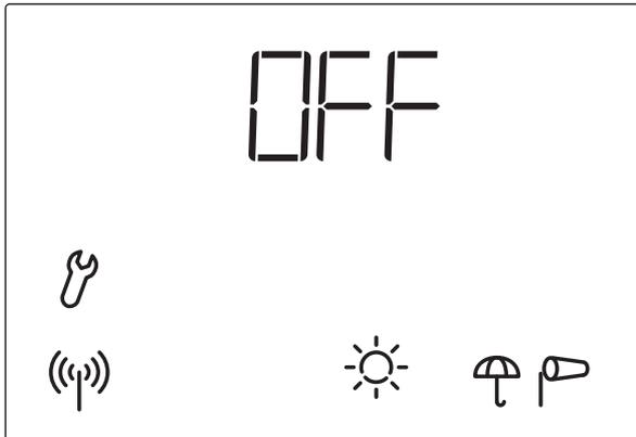
Belassen Sie diese Anzeige auf OFF, wenn die Arexa als normale Ein-Kanal-Steuerung verwendet wird. Die Funktion „Senden der Wetter- und Automatikdaten“ muss nur aktiviert werden, wenn die Arexa im Steuerungssystem XS mit Motorsteuergeräten (z. B. XS MSG2-AP) zusammenarbeiten soll.
