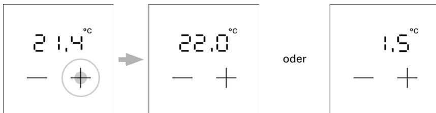
Touch-Taste **+** oder **-** kurz berühren: Die aktuelle **Solltemperatur** (oder die Basissollwertverschiebung) wird angezeigt.
