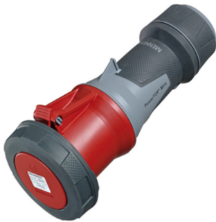
MENNEKES GEE-Kupplung HW/VN 125A 5p 400V 6h IP67
