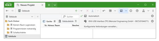
Durch Anklicken einer Verbindung wird diese als gewünschte Schnittstelle gewählt.
