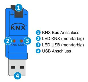
Die Spannungsversorgung erfolgt über den USB Anschluss durch den PC.
