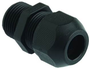
AGRO Kabelversch. SYNTEC PA6 M16 schwarz RAL9005 Ø4,5-10mm (UL 5,7-10)
