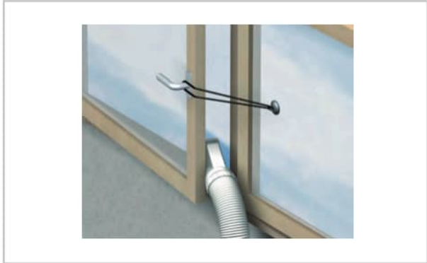
Abb. 10: Abluft bei geöffnetem Fenster
