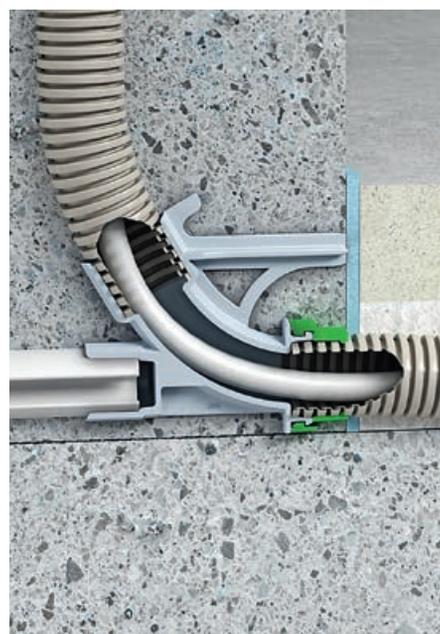
Die Krümmen verfügen über einen optimalen Radius und ermöglichen somit ein leichtgängiges Einziehen von Leitungen.
