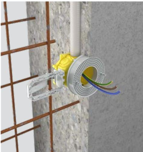
Die neuen Prefix<sup>®</sup>-Systemflügel können an alle Dosenkörper angebracht werden. Jede B<sup>1</sup> Dose ist mit zwei Aufnahmen für die Prefix<sup>®</sup>-Systemflügel ausgestattet, um eine einfache Installation ohne Abstützung zu ermöglichen.
