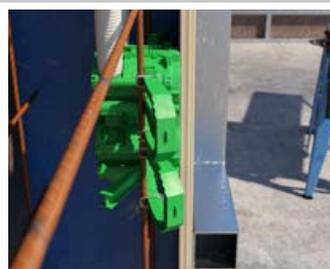
Der Zusammenbau der Dose für eine Betonüberdeckung von **20 bis 40 mm** erfolgt durch die Ausführung der Rohreinführungen am Dosenboden.
