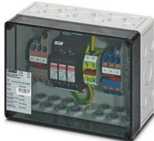
Generatoranschlusskasten für Photovoltaikanlagen bis 1000 V DC zum Anschluss von 1x 3 Strings. Mit Überspannungsschutz (Typ 1/2) und Kabelverschraubungen für die Eingangs- und Ausgangsseite.
