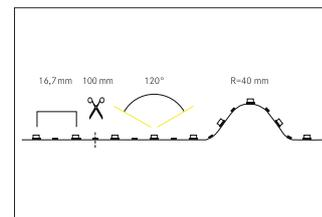
QualityFlex Offshore CLEAR, 5 m, CRI > 90, 6 W / m, IP68, LED-Weißlicht, 3.000K, CRI > 90 LED-Flexplatine Länge: 5000.0 mm Lampenleistung je Meter: 6.0 W/m, Lichtstrom je Meter: 405.0 lm/m, Schutzart raumseitig: IP68, Schutzklasse: III, Spannung: 24V , Abstrahlwinkel: 120.0 °, 60 LEDs pro Meter, Chip-Abstand (Short Pitch) : 16,7mm. Fragen Sie Ihre gewünschte Systemlänge direkt bei uns an.
