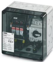
Generatoranschlusskasten für Photovoltaikanlagen bis 1000 V DC zum Anschluss von 1x 2 Strings. Mit Überspannungsschutz (Typ 1/2), DC-Lasttrennschalter und SUNCLIX-DC-Steckverbindern für die Eingangs- und Ausgangsseite (SUNCLIX-Gegenstecker im Lieferumfang).
