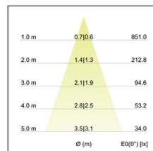
LED-Reflektoreinsatz MR16, 6 W, dim2warm, 350 mA, rund. Wird das LED-Modul gedimmt, verringert sich die Farbtemperatur. Ausführung: Plug&Play, Material: Aluminium / Glas, Schutzart raumseitig: nach DIN EN 60529: IP20, Schutzklasse: (EN 61140) III, Leistung: 6W, Lichtstrom: 430lm, Farbtemperatur: von 1.800 K bis 3.000 K, Lichtfarbe: weiß, Abstrahlwinkel: 60°, Art der Dimmung: abhängig vom Betriebsgerät.
