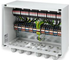
Generatoranschlusskasten für Photovoltaikanlagen bis 1000 V DC zum Anschluss von 12x 2 Strings. Gleiche Anzahl von Eingangs- und Ausgangsstrings. Mit Überspannungsschutz (Typ 1/2) und Kabelverschraubungen für die Eingangs- und Ausgangsseite.
