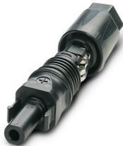
Steckverbinder, Artikelfamilie: Sunclix, Material Gehäuse: PPE, Farbe: schwarz, Polzahl: 1, Aderquerschnitt min.: 2,5 mm<sup>2</sup>, Aderquerschnitt max.: 6 mm<sup>2</sup>, Bemessungsspannung: 1100 V DC, Bemessungsstrom: 35 A, Anschlussart: Federkraft, Kontaktart: Buchse, Kabeldurchmesser min.: 5,5 mm, Kabeldurchmesser max.: 8 mm. Nachfolgeartikel von 1774674
