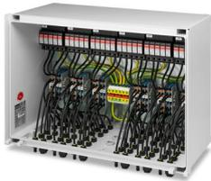
Generatoranschlusskasten für Photovoltaikanlagen bis 1000 V DC zum Anschluss von 12x 2 Strings. Mit Überspannungsschutz (Typ 1/2) und SUNCLIX-DC-Steckverbinder für die Eingangs- und Ausgangsseite.
