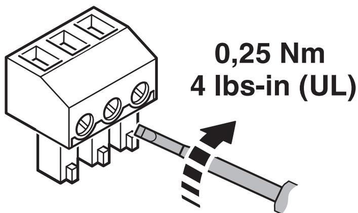
Anschluss des Fernmeldekonzakts am Überspannungsschutz
