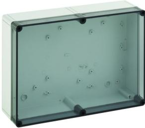
Leergehäuse TK PS 3625-11-to, Leergehäuse, Kasten: Polystyrol, grau, ähnlich RAL 7035, Deckel: Polycarbonat, transparent, Schutzart IP66, mit Schutzgrad IK07, Schutzklasse II, Bemessungsisolationsspannung  $U_i$  690VAC/DC,  $U_i$ =1000VDC, Halogenfrei, 361 x 254 x 111, ohne Vorprägungen, mit metrischen Vorprägungen,
