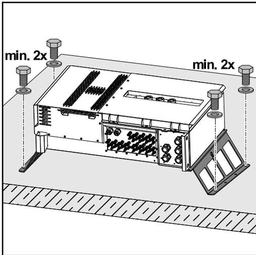
Das Befestigen des Wechselrichters auf einer horizontalen Montagefläche ist nicht zwingend erforderlich, wird aber empfohlen.
