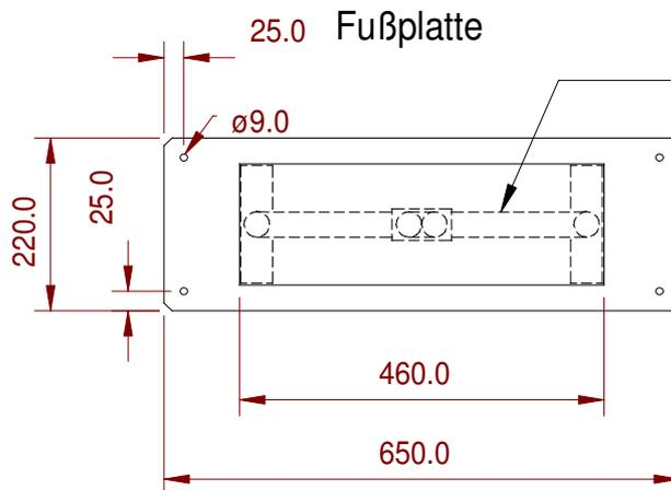
in der mittleren Aussparung sind 2 flexible Kunststoffrohre KU-E-LF 32mm nach außen in das Hohlprofil gezogen. Die beiden Hohlprofile 40x150mm (Außenmaß) dienen als Trägerprofil und als Kabelkanal.
