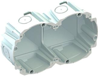
Quickbox H1, für den Einbau in Hohlwände oder brennbare Materialien, für Plattenstärke 7 - 35 mm, Material: ABS, Eigenschaften: Halogenfrei nach IEC 60754-1, Glühdrahtprüfung: 850°C nach EN 60695-2-11, Kombination: 2x1, Fräsloch Ø: 83mm, Länge: 145mm, Breite: 83mm, Tiefe: 65mm, Rohreinführungen M20: 6, Rohreinführungen M25: 6
